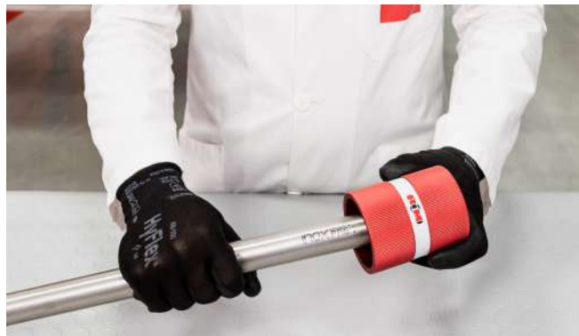
Figura 19 - Sbavatura del tubo
