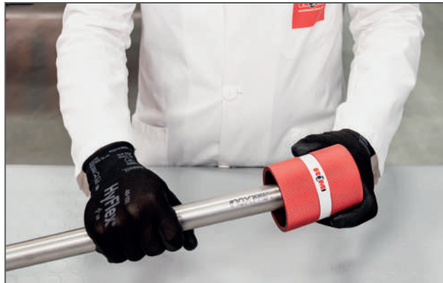
Sbavatura del tubo / Deburring the pipe
